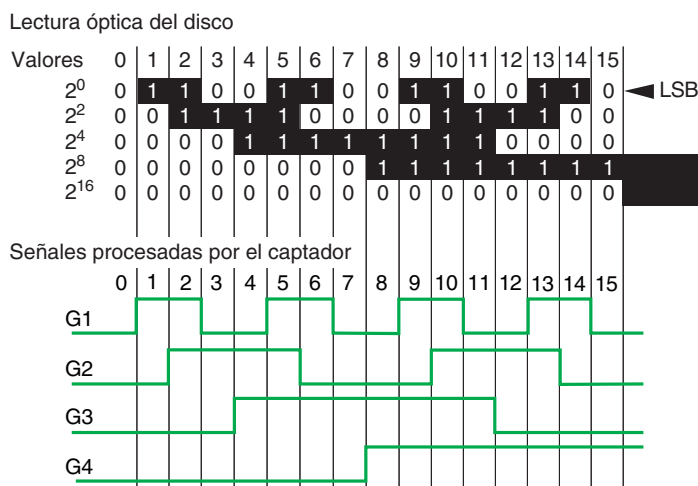
Fig. 53: Señal generada en código Gray por un codificador rotativo absoluto.
